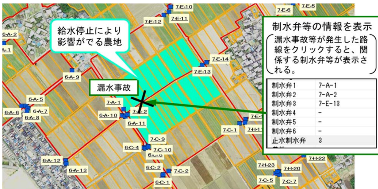
パイプラインの破損箇所と操作する制水弁及び影響を受ける農地の状況（例）
